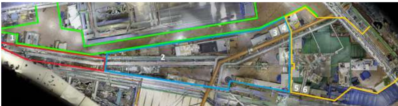
Figura 1: Vista aerea di MSB. Area del front-end e del primo specchio (rosso), resto dell'area della linea di luce (blu), area della stazione sperimentale (arancione), via di fuga (verde). I numeri indicano i 6 rack contenenti l'elettronica di controllo.
